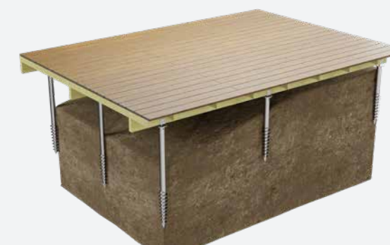
Etape 4 Pose du platelage
