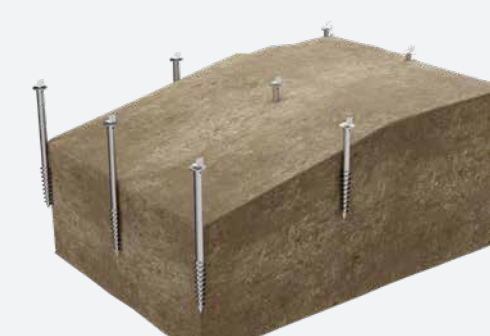
Etape 1 Installation des vis de fondation
