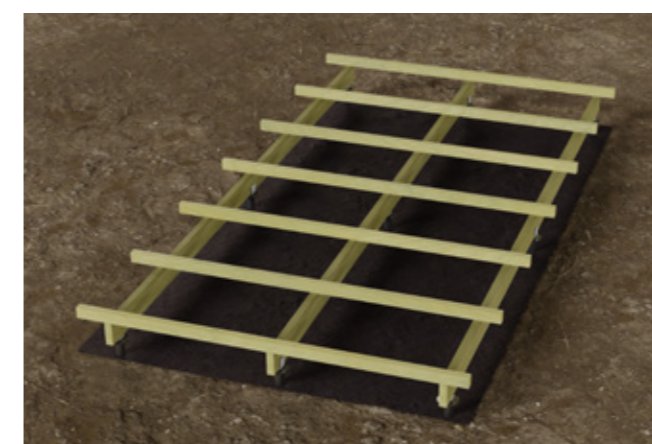
Exemple pour structure croisée en pin avec solives 45x145mm et lambourdes 45x70 mm
