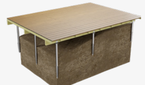
Etape 4 Pose du platelage
