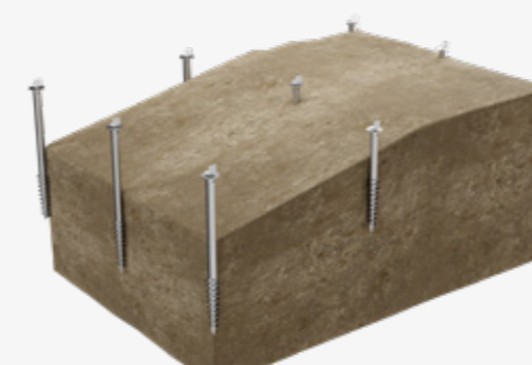
Etape 1 Installation des vis de fondation
